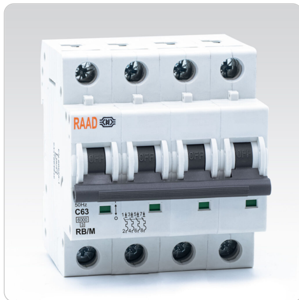
کلید مینیاتوری 4 پل با جریان 63 آمپر و جریان قطع 6 کیلوآمپر ، رنج AC و منحنی قطع C
