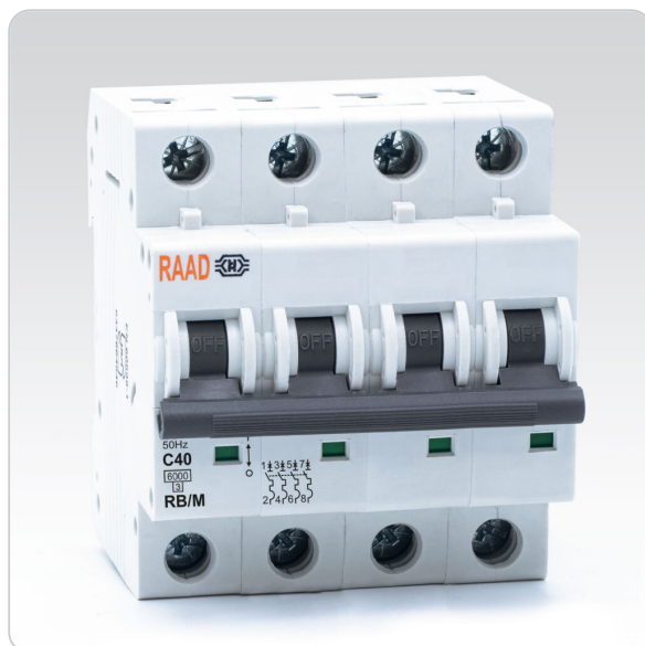
کلید مینیاتوری 4 پل با جریان 40 آمپر و جریان قطع 6 کیلوآمپر ، رنج AC و منحنی قطع C
