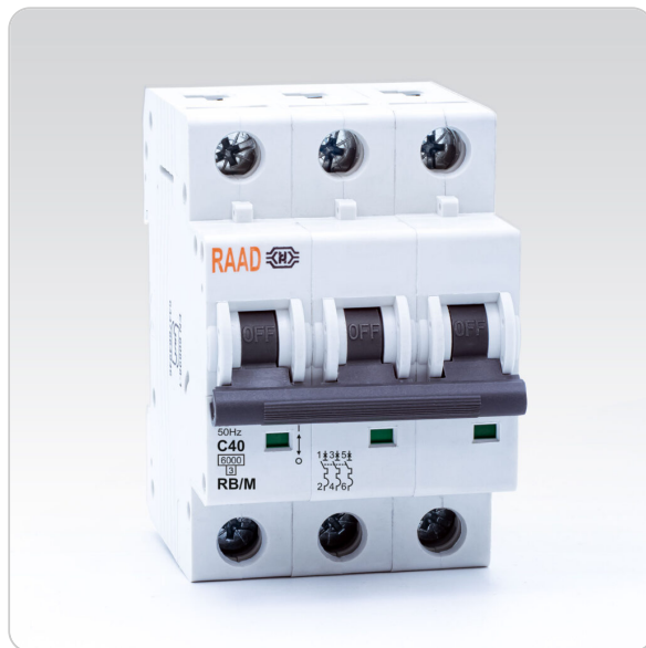
کلبید مینیاتوری 3 پل با جریان 40 آمپر و جریان قطع 6 کیلوآمپر ، رنج AC و منحنی قطع C
