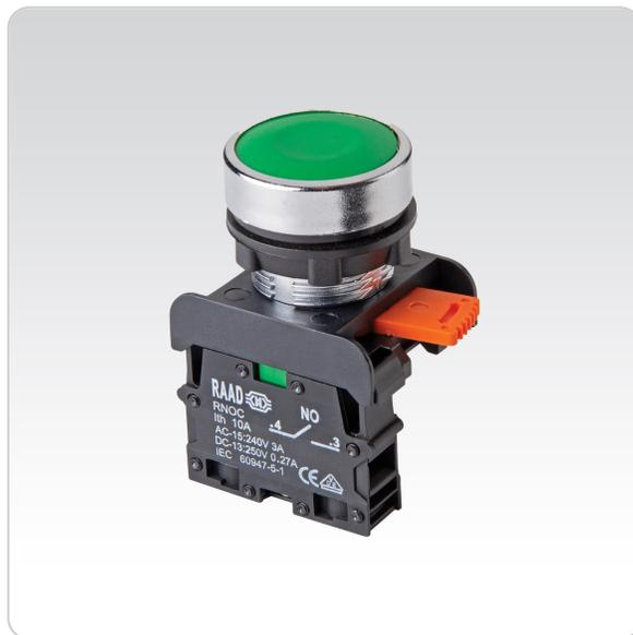
کلید های کنترل رعد مطابق با استاندارد IEC60947-5-1 و با قطر 22 میلی متر طراحی گردیده است. از انواع این کلیدها می توان به کلید استپ و استارت، کلید استپ و استارت دابل، کلید سلکتوری به همراه واشر ضد چرخش و کلید قطع اضطراری قفل شونده اشاره نمود. این محصولات در محدوده ولتاژ 240 ولت و جریان 3 آمپر تولید شده است.
