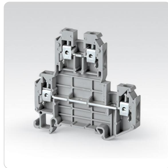
ترمینال ریلی دو طبقه پیچی ، سیم گیری به صورت پیچی با سطح مقطع 4 میلی متر با جریان نامی 32 آمپر و ولتاژ 500 ولت
